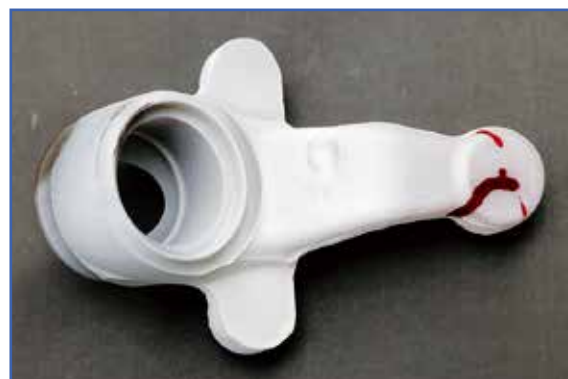
▲タセトカラーチェックによる探傷の一例
