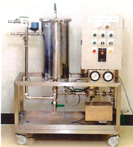
油水分離機装置の一例
